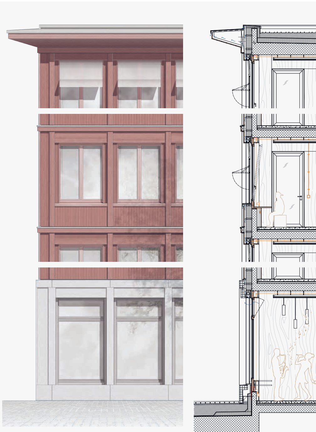
Abb. 16: Materialisierung und Fassadenkonstruktion
